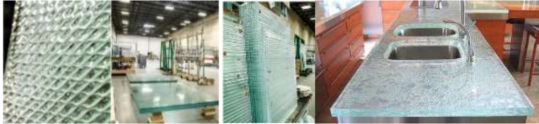
شكل رقم (٢) يوضح تفاصيل تنفيذ الزجاج المعاد تدويره و تطبيقه فالحيزات الداخلية. (Muneneh, 2013)
