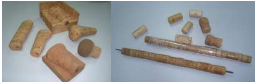
شكل رقم (١) مقابض و عمود مصنوعين من الفلين و بهم نقر و لسان للتعشيق. (Gil, L. 2015)
