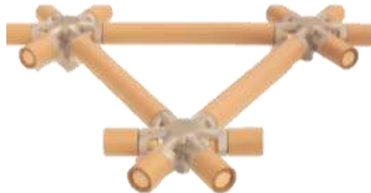
شكل رقم ( ٦ ) توضح التفاصيل التنفيذية لربط البامبو بالوصلات المعدنية لربطها معا. (Pachal, 2017).
