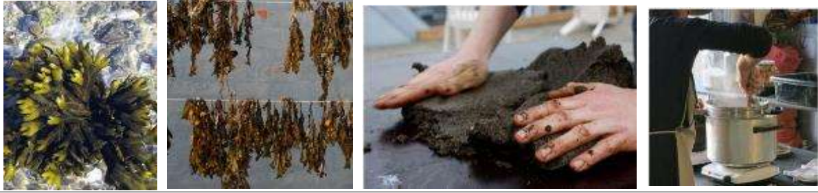
شكل رقم ( ٢١ ) يوضح مراحل تجميع و تجفيف و خلط الأعشاب البحرية مع الورق و كيفية تشكيلها . https://www.dezeen.com/2015/01/11/algae-glue-seaweed-paper-furniture-jonas-edvard-nikolaj-steenfatt/
