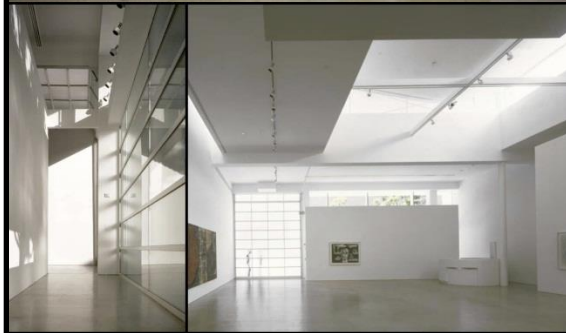
شكل (51) استخدام الزجاج في معظم حوائط المتحف وفتحات السقف الذي يعمل كأنه شبه قبة سماوية لتحقيق أقصى استفادة من الإضاءة الطبيعية ، ولحماية المقتنيات من الأشعة فوق البنفسجية استخدم الزجاج المعالج نانويًا ، وتم طلاء الحوائط بدهانات تحقق خاصية التنظيف الذاتي بتأثير اللوتس ، ومعالجة الأرضيات بمواد نانوية تزيد من صلابتها وإطالة عمرها .
