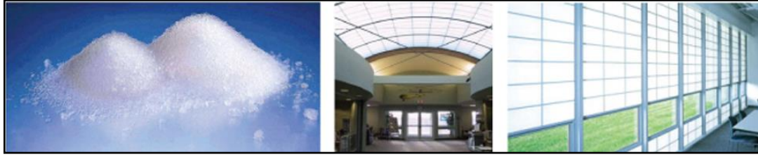
شكل (8) حبيبات الإيروجل واستخدامها في تدعيم الأسطح الزجاجية للأسقف والحوائط https://www.designingbuildings.co.uk/wiki/Aerogel_insulation_for_buildings
