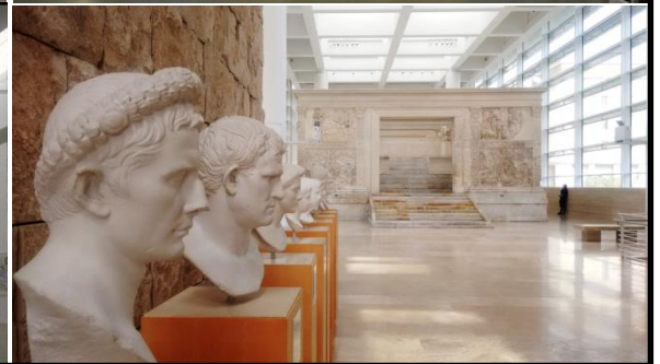
شكل (51) استخدام الزجاج في معظم حوائط المتحف وفتحات السقف الذي يعمل كأنه شبه قبة سماوية لتحقيق أقصى استفادة من الإضاءة الطبيعية ، ولحماية المقتنيات من الأشعة فوق البنفسجية استخدم الزجاج المعالج نانويًا ، وتم طلاء الحوائط بدهانات تحقق خاصية التنظيف الذاتي بتأثير اللوتس ، ومعالجة الأرضيات بمواد نانوية تزيد من صلابتها وإطالة عمرها .
